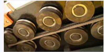
Les roues à dresser sont fabriquées avec des matériaux de qualité supérieure et traitées thermiquement. Cela rend la machine d'abord et les pièces ensuite très agiles.
